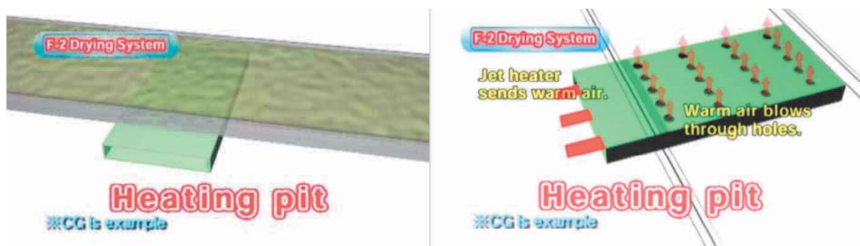
Фиг.6 Система за доизсушаване - схема
